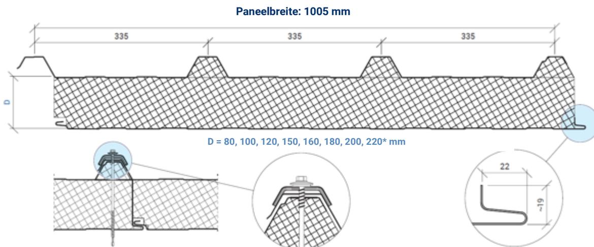
\*Kernstärke 220 mm wird auf Sonderbestellung nach Absprache mit dem Hersteller gefertigt
